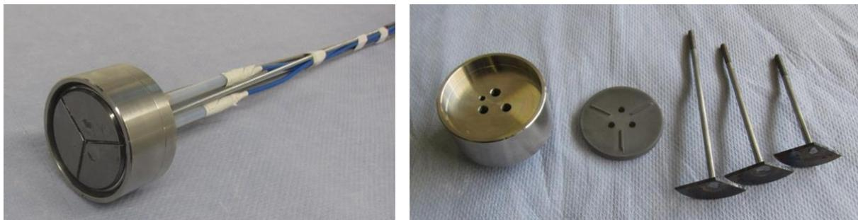
Abbildung 3–5: Korrosionsmesssonde im Zusammenbau (rechts) und in Einzelteilen (links) mit Sondenkopf, Isolator und Elektroden
