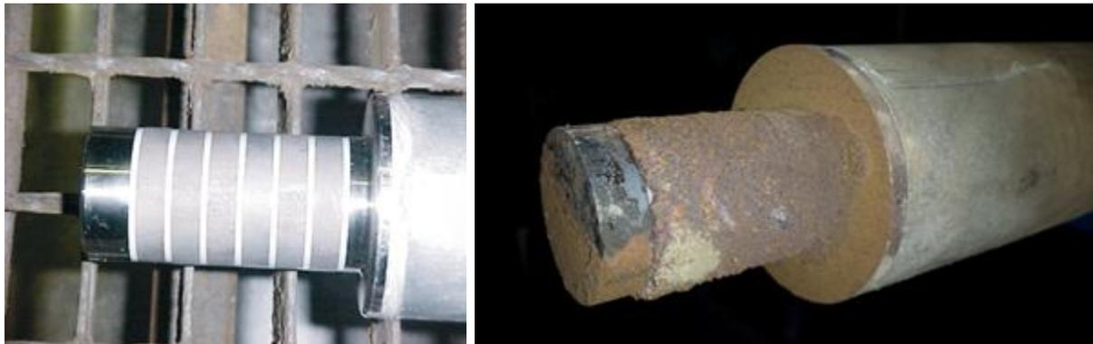
Abbildung 3–64: Vor (linkes Bild) und nach (rechtes Bild) dem Einsatz der Korrosionssonde an einer Großanlage
