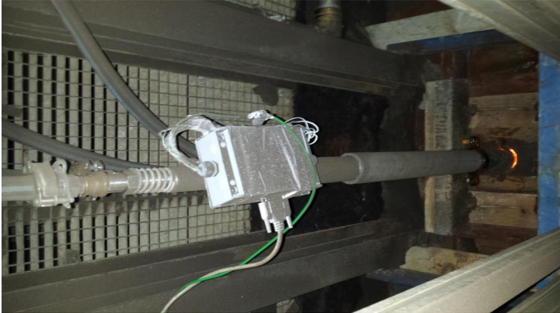
Abbildung 3–63: Einbau der LUAT-Korrosionssonde in einer Großanlage der Firma RWE Power AG
