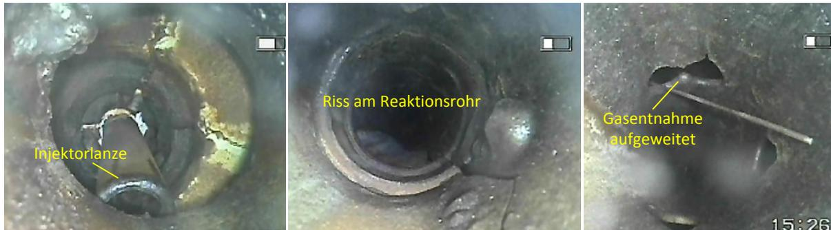
Abbildung 3–88: Beschädigungen am Reaktionsrohr
