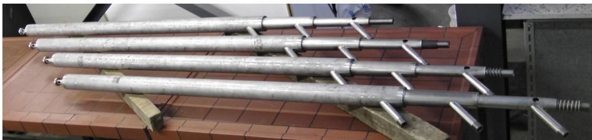
Abbildung 3–44: Korrosionssonden für den Kraftwerkseinsatz
