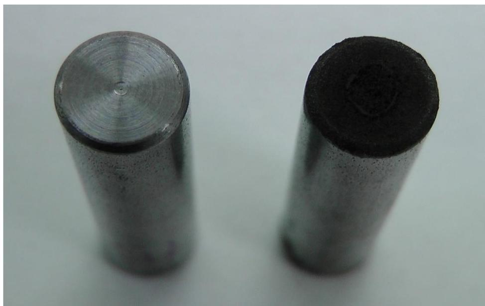
Abbildung 3–51: Elektrode vor (links) und nach (rechts) der Korrosionsmessung in korrosiven Lösungen
