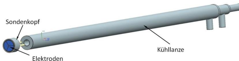
Abbildung 3–1: Aufbau der Korrosionsmesssonde des EST
