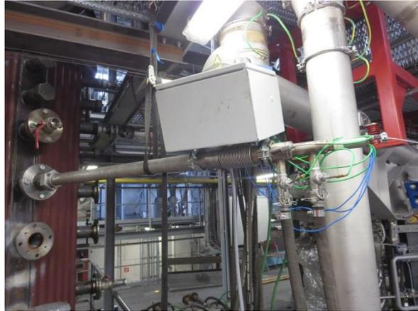
Abbildung 3–18: Eingebaute Korrosionssonde an der 1MW<sub>th</sub> Brennkammer
